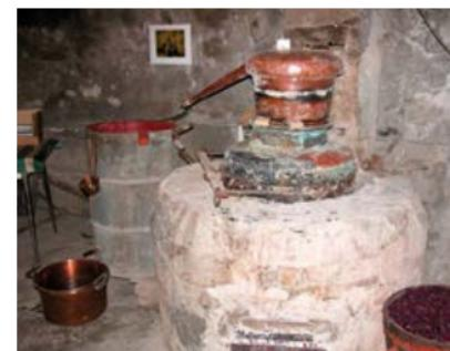
■ ■ *Le bâtiment des écoles primaires abrite, au rez-de-chaussée, le four à bois de la communauté, deux pompes à incendie manuelles et l'alambic de la coopérative pour la distillation de l'eau-de-vie. Ce dernier a été fabriqué en 1976 par la Coopérative de Développement Agricole "Alpe Soulliet" et il est encore utilisé, à partir des premiers jours de décembre, en permettant aux producteurs de vin de la région de produire son eau-de-vie selon les normes en vigueur.*
